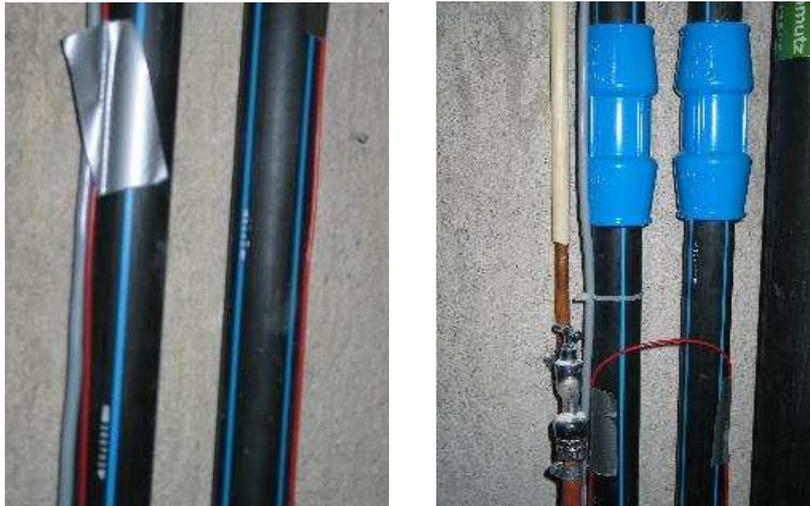
**Bild 12** Erweiterung des Versuchs mit den Kühlwasserleitungen durch F. Balck: Anbringung eines Leitungsdrahtes (rot)
