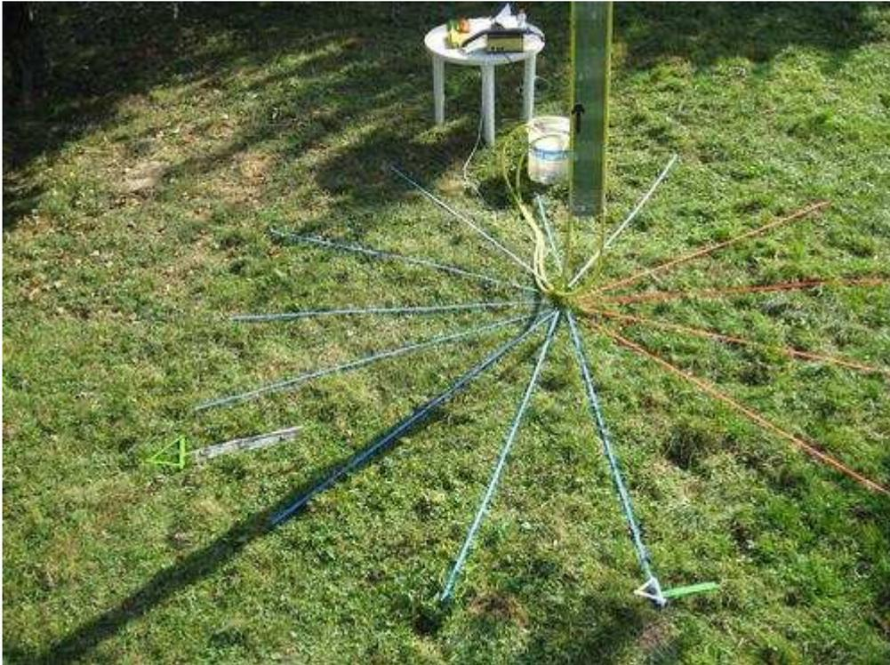
**Bild 21** Versuch ohne Gleichstrom: Radiale Reizstreifen sind sofort wieder nutzbar
